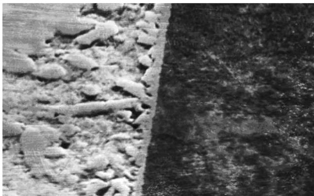
Рис. 2. Микроструктура биметалла сталь Ст. 3 – баббит Б 83,  $\times 1000$
