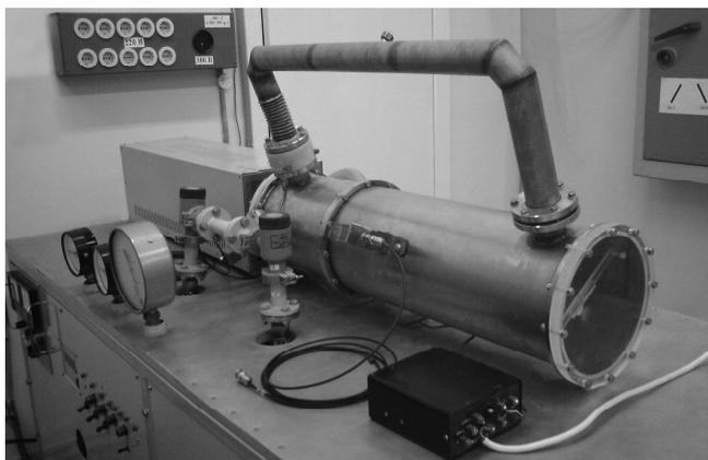
Рис. 2. Внешний вид установки для конверсии сероуглерода под действием стримерной короны
