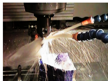
Рисунок. Обработка детали на вертикально-сверлильном станке с применением СОЖ
