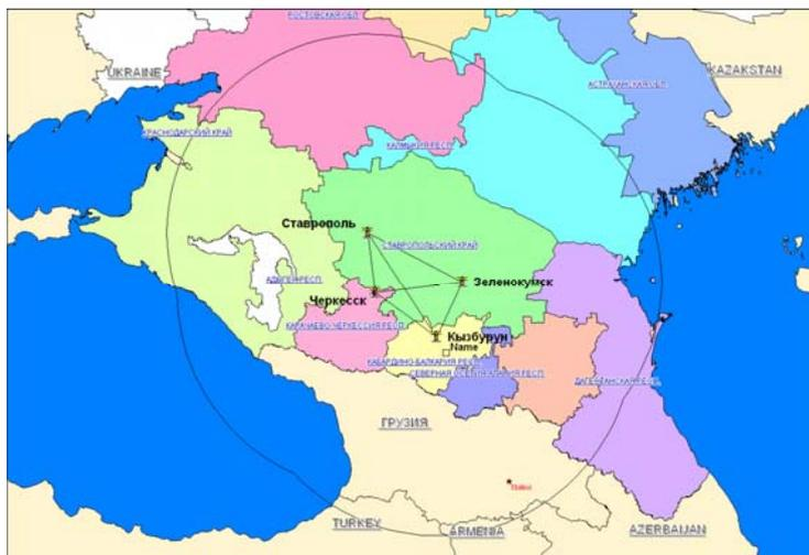
Рисунок. Территория сбора и регистрации грозоразрядной информации (обозначения на рисунке: \_\_\_\_\_ границы инструментальных наблюдений с использованием грозорегистратора LS8000 и метеорадиолокатора МРЛ-5;  – различными цветами разделены республики Северного Кавказа;  – местоположение датчиков грозорегистратора)
