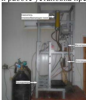
Рис. 1. Установка по плазмохимическому синтезу наночастиц металлов
