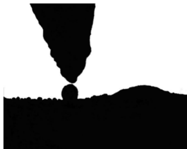
Рис. 4. Позиционирование острия кантилевера ( R \approx 10 \text{ нм} – радиус острия) с наноклейкой олова диаметром около 20 нм, лежащей на пленке золота, нанесенной на поверхности твердого тела (увеличение \sim 2 \cdot 10^5 )
