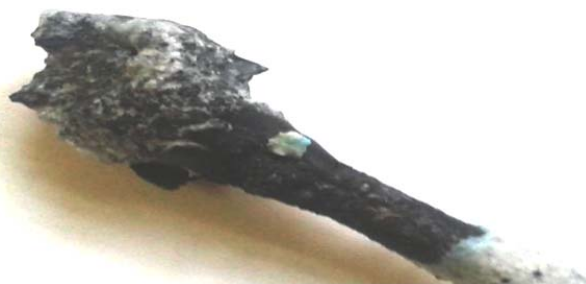
Рис. 9. Фотографический снимок (увеличение в 4 раза) металлосолевой «груши», полученной на вольфрамовом электроде гальваностатическим электролизом расплава \text{NaCl-KCl-SmCl}_3\text{-CoCl}_2\text{-KBF}_4 при температуре 973 К
