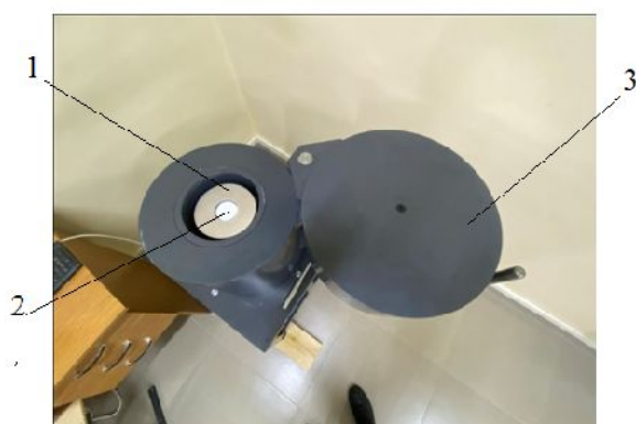
Рисунок 2 – Вид спектрометра внутри контейнера: 1 – сцинтилляционный детектор МКГБ-01 «РАДЭК» в свинцовом контейнере в пассивной защите (толщина стенок 100 мм, 4л – геометрия); 2 – бериллиевое окно детектора; 3 – крышка контейнера
