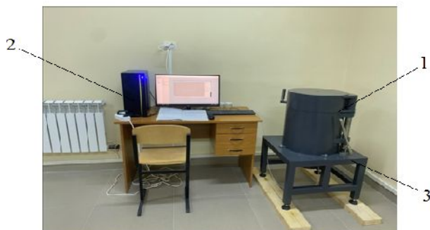
Рисунок 1 – Общий вид сцинтилляционного спектрометра МКГБ-01 «РАДЭК» в составе: 1 – пассивная защита в виде свинцового контейнера со сдвигаемой крышкой с механическим приводом; 2 – ПК с модулем расширения АЦП и рабочей программой анализатора для визуализации спектра регистрируемых гамма-квантов; 3 – станина для защитного контейнера со сцинтилляционным детектором внутри
