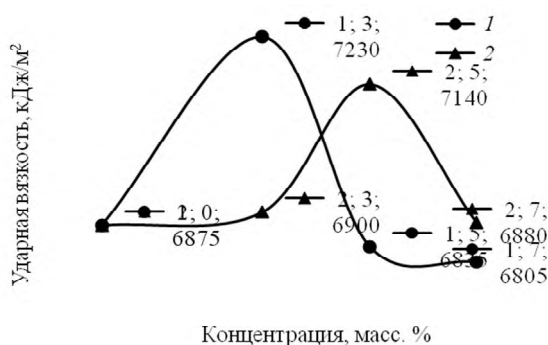
Рисунок 2 – Зависимость ударной вязкости нанокomпозитов от состава содержания органоглины: 1 – органоглина с АГ; 2 – органоглина с МАГ
