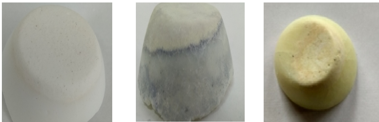
Рис. 1. Фотографический снимок солевого плава, полученного при добавлении в систему NaCl–KCl–Na 2 WO 4 : 1) LaCl 3 ; 2) CeCl 3 ; 3) Sm Cl 3 . Время синтеза – 60 мин. Соотношение компонентов синтеза 1:4
