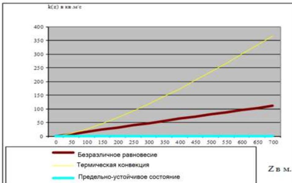
Рис. 2. Расчетные значения среднего профиля коэффициента турбулентности при различной стратификации пограничного слоя
