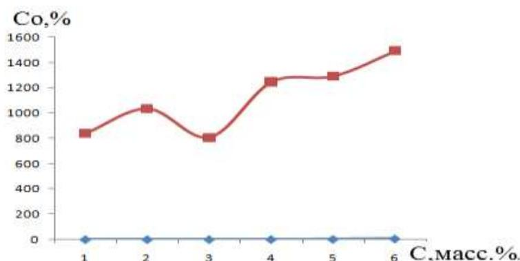
Рис. 6. Зависимость содержания атомов кислорода от концентрации слоистого силиката в смеси 80 % СКИ-3 + 20 % ПЭНП
