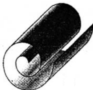
Рисунок. Структура МУНТ. Модель поперечного сечения многослойных нанотрубок типа «сверток»
