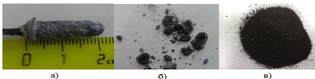
Рис. 5. Фотографический снимок груши (а), продукт электролиза до отмывки (б) и полученный после отмывки порошок (в), полученные электрохимическим синтезом в системе  $\text{CeCl}_3(6,70)\text{-KBF}_4(9,66)\text{-KCl}(14,57)\text{-NaCl}(14,10)\text{-CsCl}(58,97)$  массовых частей при напряжении на ванне 2,7 В и  $T = 823 \text{ K}$
