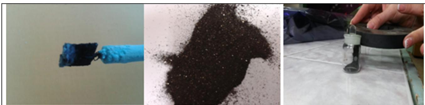
Рис. 4. Фотографический снимок груши (а), продукт электролиза до отмывки (б) и полученный после отмывки порошок (в), полученные электрохимическим синтезом в системе CeCl<sub>3</sub>(6,70)–CoCl<sub>2</sub>(3.2)–KBF<sub>4</sub>(9,66)–KCl(14,57)–NaCl(14,10) массовых частей при напряжении на ванне 2,7 В T=973 К
