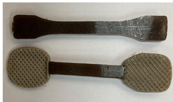
Рис. 3. Образец ПЭЭК (а) и сПЭЭК (б) до испытания (верхний) и после испытания при 200 °C (нижний)
