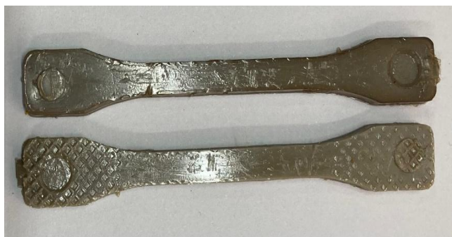
Рис. 3. Образец ПЭЭК (а) и сПЭЭК (б) до испытания (верхний) и после испытания при 200 °C (нижний)
