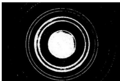
Рис.5. Электронная дифрактограмма закристаллизованной после отжига электронным лучом тонкой пленки \text{K}_{0.3}\text{WO}_3 с температурой подложки 373 К
