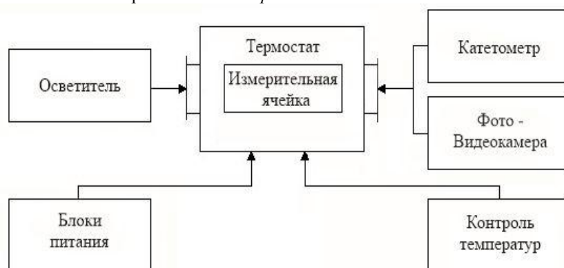
Рис. 1. Блок-схема экспериментальной установки для изучения температурной зависимости краевых углов смачиваемости поверхностей твердых тел жидкими металлами и сплавами
