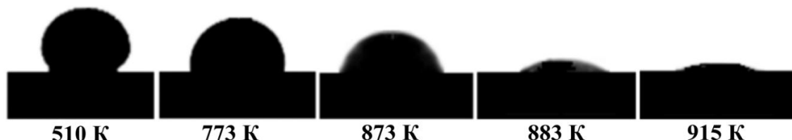
Рис. 2. Видеоизображения профилей капли жидкого олова, лежащей на подложке из полированной стали 12X18H9T при различных температурах
