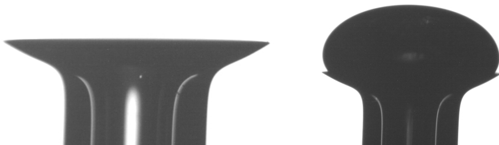
Рис. 2. Чашка-подложка до и после начала измерения поверхностного натяжения расплава PbBi
