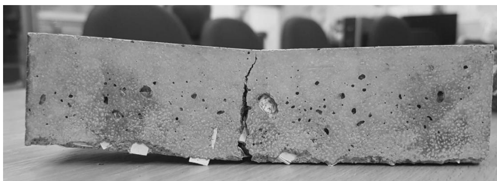
Рис. 5. Неполное разрушение образцов с добавлением ПВХ
