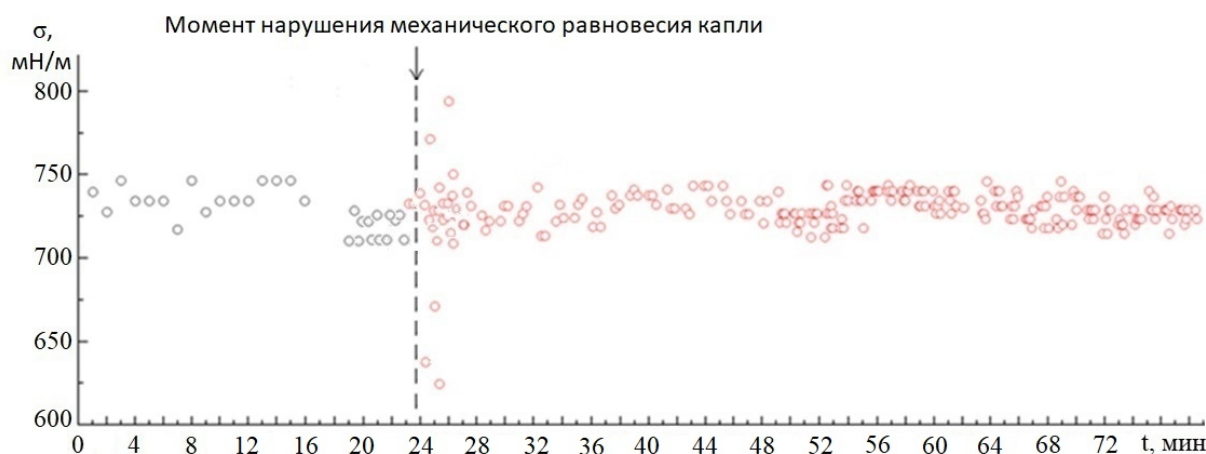
Рис. 3. Зависимость поверхностного натяжения большой лежащей капли чистого галлия в вакууме от времени в равновесном неподвижном состоянии и в момент вывода капли из механического равновесия на 25-й минуте с начала эксперимента
