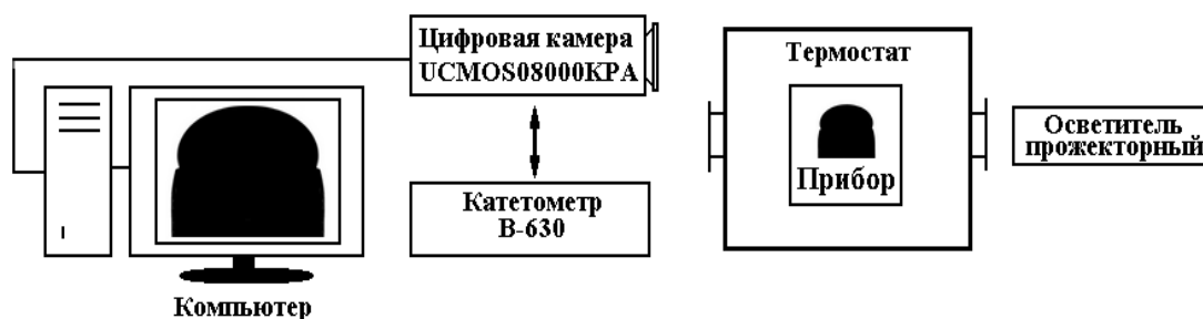
Рис. 2. Блок-схема экспериментальной установки для измерения поверхностного натяжения жидких металлов методом большой лежащей капли
