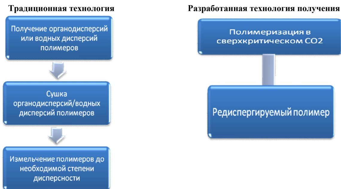
Рисунок. Способы получения редиспергируемых в воде полимеров
