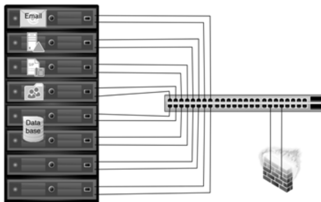
Рис. 1. Схема подключения физических серверов
