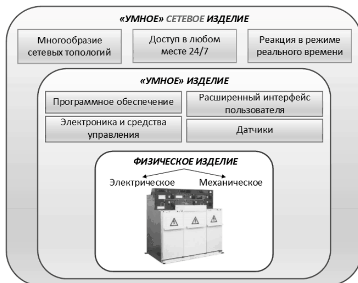
Рис. 4. Принцип построения и задачи умного сетевого изделия
