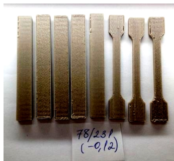
Рис. 5. Образцы напечатанного композита на основе ПФСн, содержащего 35 % СВ (0,2 мм) и 15 % ОФСн
