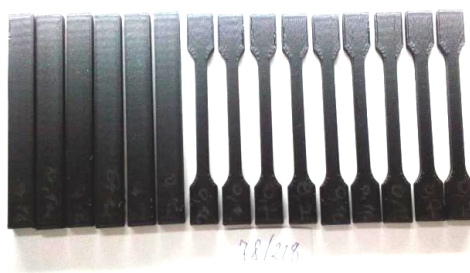
Рис. 4. Образцы напечатанного композита на основе ПФСн, содержащего 30 % УВ (0,2 мм) и 13 % ОФСн
