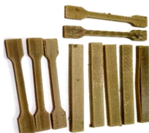
Рис. 2. Образцы напечатанного композита на основе ПФСн, содержащего 25 % стекловолокон (СВ 0,2 мм) и 20 % ПФСн
