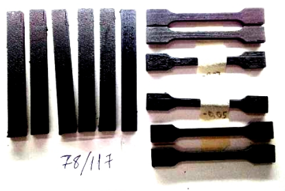
Рис. 3. Образцы напечатанного композита на основе ПФСн, содержащего 25 % УВ (0,2 мм) и 10 % ОФСн
