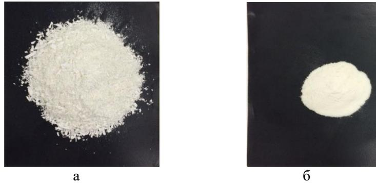
Рис. 8. Снимки некапсулированного (а) и капсулированного (б) образцов ПЭЭК (I) массой по 5 г
